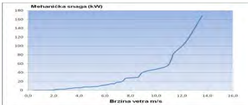
Слика 3. Функционална зависност механичке снаге од израчунате брзине ветра на висини стуба од 60 m
