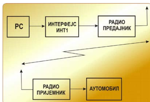
Slika 9: ŠEMA UPRAVLJANJA NA DALJINU: primer upravljanja modelom automobila korišćenjem INT1 i radio predajnika i prijemnika
