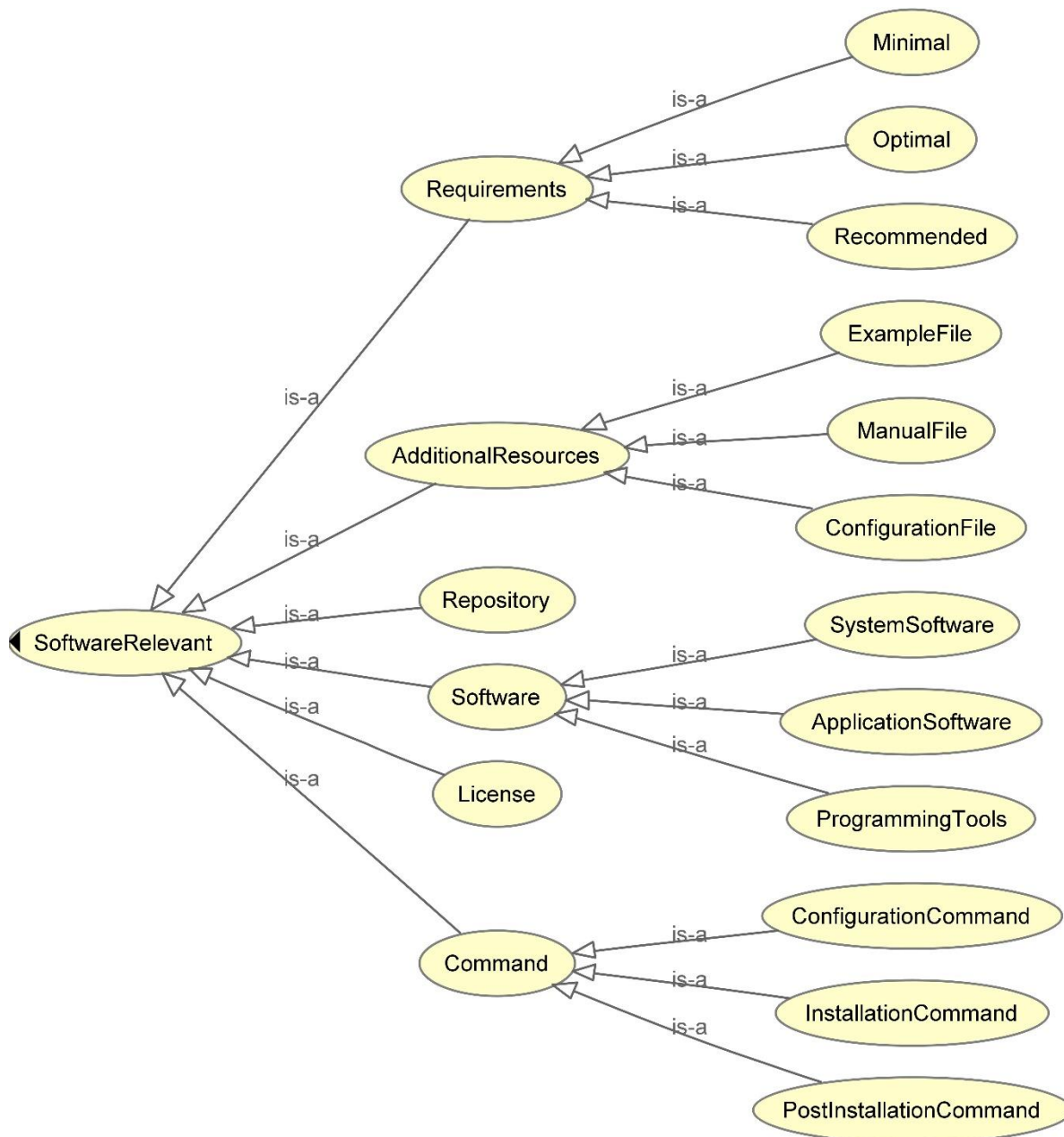
Слика 38. Хијерархија класа садржаних у оквиру класе SoftwareRelevant коришћењем OWLViz додатка у оквиру Protégé десктоп окружења
